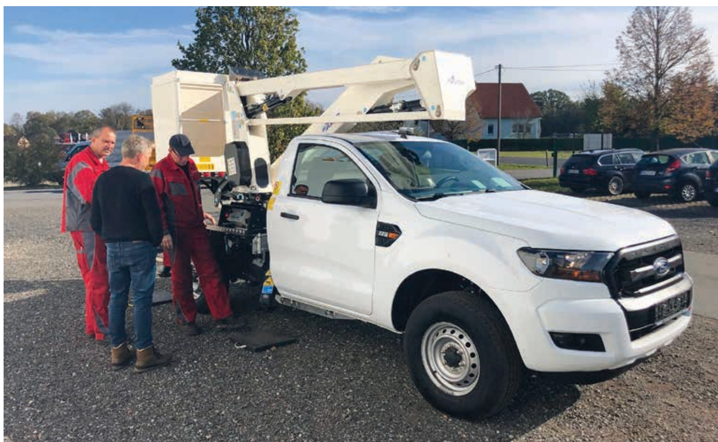
Die auf Fernmelde- und Breitbandkabel-Montage spezialisierte Berliner Firma Prokom ETF erhält eine GSR E140P, aufgebaut auf geländegängigem Pickup-Chassis Ford Ranger. Mit einer Arbeitsbreite von minimal 2,12 Meter – die Durchfahrbreite beträgt lediglich 1,85 Meter – und einem Eigengewicht von nur 3.200 Kilogramm eignet sich das Gerät besonders gut für die speziellen Einsätze der Firma, die häufig in beengten Straßen, Hinterhöfen und unbefestigten Gartenanlagen der Hauptstadt vonstattengehen. <<
